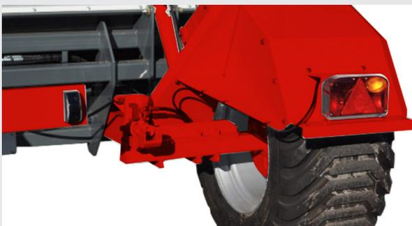
Les roues sont équipées d'une hauteur réglables indépendantes ce qui permet de régler la hauteur d'épandage en fonction de la pente.
