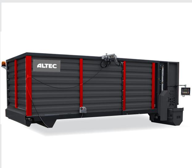
Installée en poste fixe et entraînée par un moteur électrique cette machine peut s'intégrer dans un système d'alimentation automatisée cherchant à distribuer du foin en vrac. Elle peut être équipée de pesons pour maîtriser la distribution par lot.
