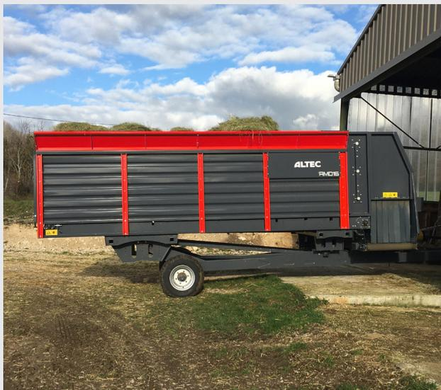
Machine attelée derrière un tracteur, elle n'a besoin d'un tracteur que de 40 CV pour assurer la distribution du foin. La prise de force entraîne les fonctions hydraulique de machine, la distribution est effectuée en mouvement depuis la cabine tracteur en version tapis.
