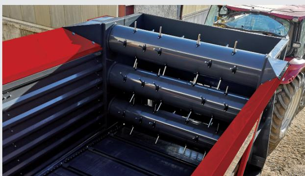
Les démêleurs sont équipés de dents rétractables qui permettent aux produits longs d'être amenés avec régularité à la vis sans fin de distribution et évitent l'enroulement de la matière au démêleur. Cet ensemble possède un contrôle d'effort pour éviter un surplus de matière à la vis.
