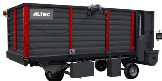
Pour ne pas réquisitionner un tracteur à l'année, la RMD est disponible en version thermique ou électrique pilotable à distance par l'intermédiaire d'une commande filaire qui contrôle l'ensemble des déplacements de la machine. Le pilotage de la distribution est déportée au niveau de la vis pour piloter la distribution sur les tapis mécanisés.
