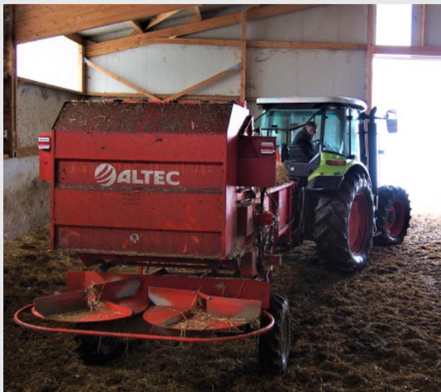
Situés en sortie de démêleurs, ces disques de paillage assurent un éparpillé de paille d'une largeur de 6 m.
