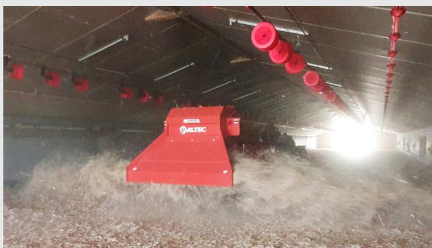
La vitesse du fond mouvant est réglée par un contrôle d'effort afin d'éviter le surplus de matière au niveau des démêleurs et assurer un paillage et une distribution homogène.
