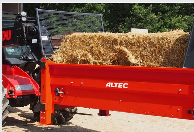
Accessoire pour la manutention des balles rondes et carrées, il est équipé de 2 dents de 130 cm Ø 40 mm et d'un entraxe de 90 cm entre les deux dents. Il est équipé d'une connexion hydraulique automatique pour éviter de descendre du télesco pour piloter les fonctions hydrauliques de la machine.
