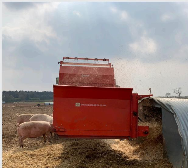
Situé en sortie de démêleurs, ce tapis chaîne barrette permet une distribution de fourrage au pied des cornadis à gauche ou à droite. En option sur version tapis, il est possible de positionner un projecteur à peigne rabattable hydrauliquement qui permet de projeter la paille sur la côté à 5 m.
