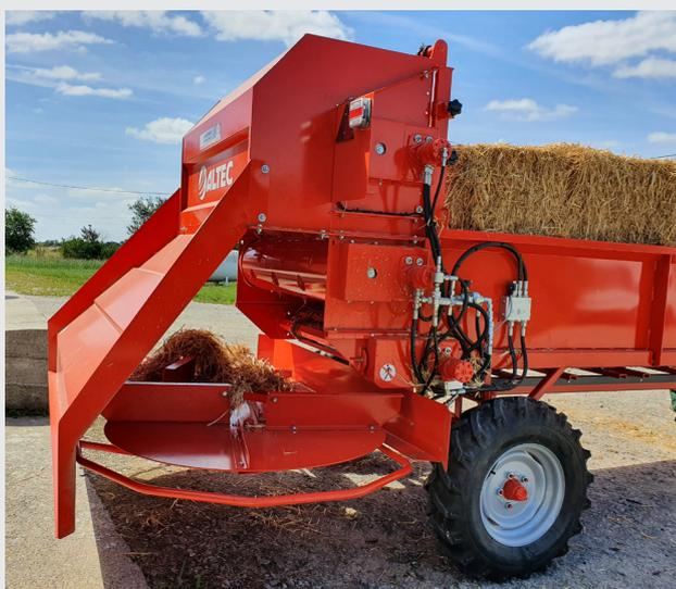
Spécialement conçue pour les bâtiments avicoles, cette hotte canalise le flux de paille en sortie de démêleurs assurant un paillage homogène sur une largeur de travail de 12 m par passage.
