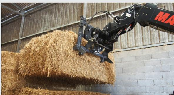
Accessoire pour la manutention des balles rondes et carrées, il est équipé de 2 dents de 115 cm Ø 40 mm et d'un entraxe de 90 cm entre les deux dents.
