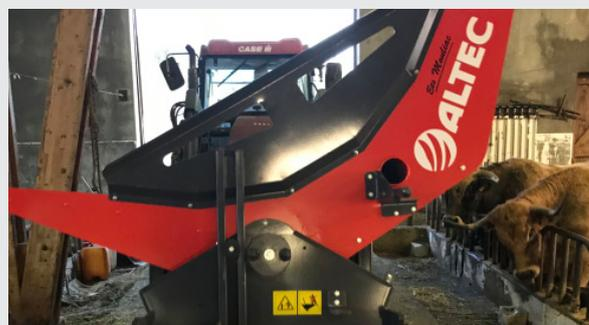
Disponible sur la version DR 170 I Pic, la caisse inclinable permet de contrôler la position de la botte dans la dérouleuse et assure le déroulage du noyau.
