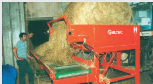
Machine conçue sur châssis indépendant pour le déroulage sur tapis mécanisés. La distribution peut s'effectuer à droite ou à gauche, le tapis à barrettes droites et métalliques possède une hauteur ajustable en 3 positions de 40 à 52 cm du sol.
