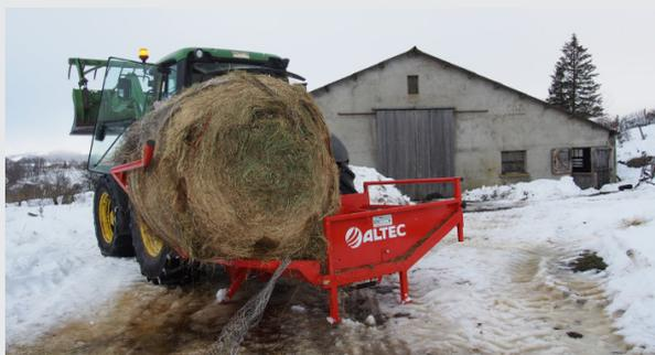
Option, la dérouleuse peut être équipée d'un bras de chargement qui permet de charger en toute autonomie la balle dans la caisse de la dérouleuse.
