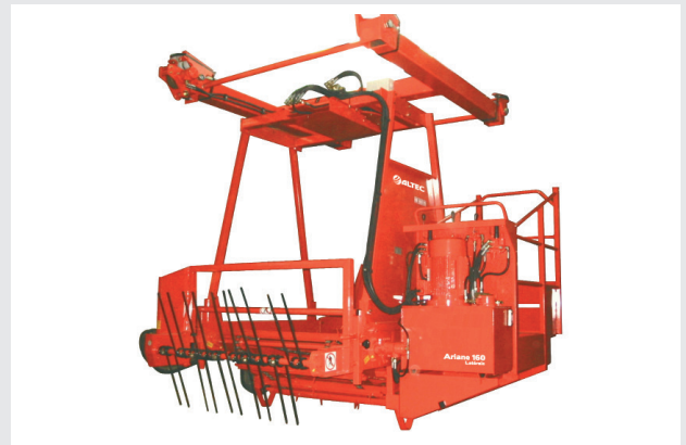
Paillage à peignes profondeur de paillage 5 à 6 m.
