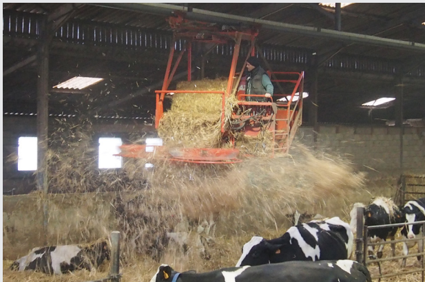
Paillage à disques largeur de paillage 8 m.
